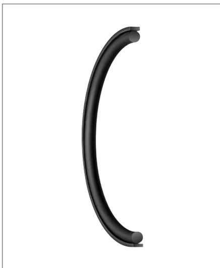
Der doppelt wirkende Kolbendichtsatz Profil OA besteht aus einem PTFE-Kolbendichtring und einem Elastomer-O-Ring als Vorspannelement.
