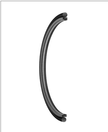
Der einfachwirkende Stangendichtsatz Profil OD besteht aus einem PTFE-Stangendichtring und einem Elastomer-O-Ring als Vorspannelement. Der asymmetrische Querschnitt des Dichtringes ist für optimale Schleppölrückförderung während des Hubs in beiden Richtungen ausgelegt. Die optimale Dichtwirkung wird durch den Einbau in Tandem-Anordnung in Verbindung mit einem Doppelabstreifring erreicht.
