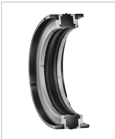
Der doppelwirkende Kolbendichtsatz Profil ZW besteht aus einem Elastomer-Dichtteil, zwei Anti-Extrusions- und zwei Winkelführungsringen.
