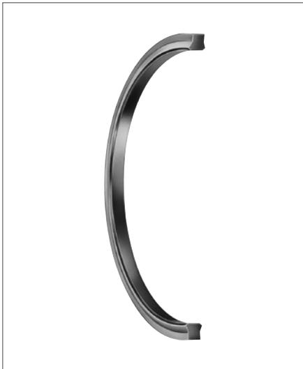
In vielen Fällen sind Standard-O-Ringe auf Grund der Randbedingungen, wie hohe Drücke und ungeeignete Oberflächengüten der Flansche, nicht einsetzbar. Speziell für SAE-Flansche wurde deshalb die Ultrathan®-Flanschdichtung Profil OV entwickelt.
