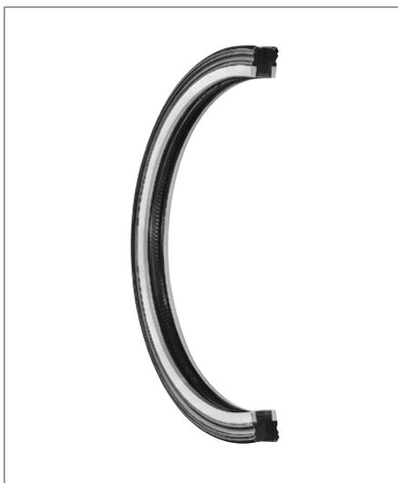
Der Rotordichtsatz Profil KA besteht aus einem gewebeverstärkten Gummidichtring und zwei Anti-Extrusionsringen. Diese erhöhen die Stabilität und verhindern eine Extrusion in den Spalt, der – durch die Drehbewegung bedingt (Exzentrizität) – in den meisten Fällen variabel ist.
