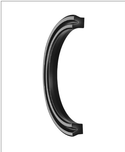
Die Ultrathan®-Kolbendichtung Profil B7 ist ein Lippenring mit Festsitz am Innendurchmesser. Diese Dichtung kommt zum Einsatz, wenn die physikalischen Eigenschaften normaler oder gewebeverstärkter Elastomere nicht mehr ausreichen.
