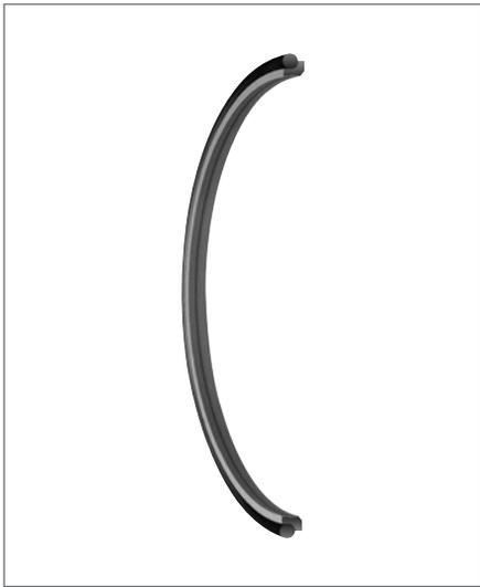
Abstreifringe haben die Aufgabe, das Eindringen von Staub, Schmutz, Sandkörnchen und Metallspänen an axial bewegten Stangen und Plungern zu verhindern. Sie verhindern damit weitgehend die Riefenbildung, schützen Führungselemente und Dichtungen und verlängern so die Betriebsdauer des Dichtsystems.
