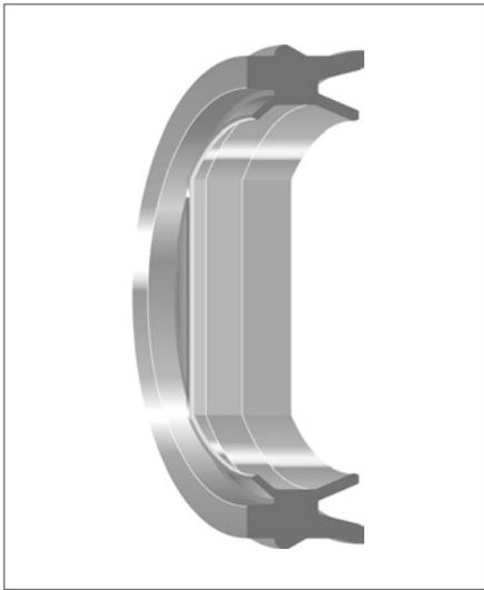
Der selbstsichernde Pneumatik-Dicht-Abstreifring ET für abgeflachte Kolbenstangen von verdrehgesicherten Pneumatikzylindern ist das ovale Pendant zum runden Standard-Profil EU. Er erfüllt gleichzeitig drei Funktionen: **Dichten, Abstreifen, Fixieren.**
