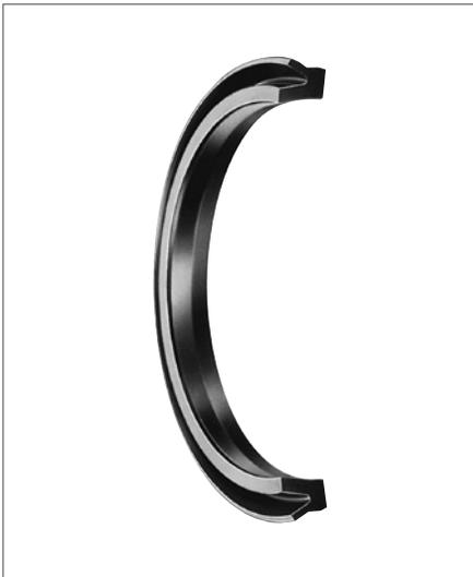
Die Kolbendichtung Profil E4 ist ein Lippenring speziell für den Einsatz in der Pneumatik. Die Abmessungen der Standard-Baureihe Profil E4 entsprechen den Zylinderdurchmessern nach ISO 3320 bzw. CETOP RP 52 P, RP 43 P und RP 53 P. Sie sind mit der Standardreihe des in der Pneumatik früher üblichen Profils C2 austauschbar.
