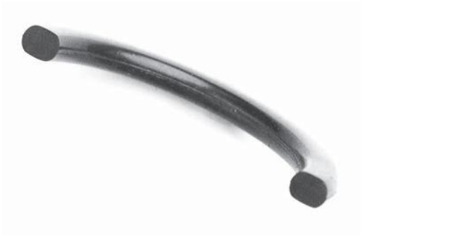
Bild 9.9 Schadensbild durch hohe bleibende Verformung (Compression Set)
