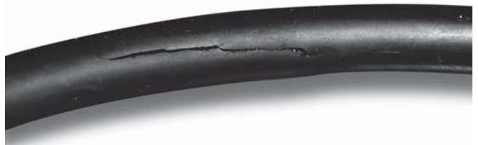
Bild 9.12 Oberflächenzerstörung durch explosive Dekompression
