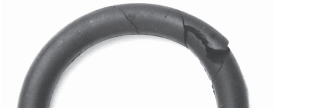
Bild 9.11 Verdrehter O-Ring mit Einschnitten in der O-Ring-Oberfläche
