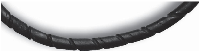
Bild 9.10 Verdrehter O-Ring mit spiralförmigen Markierungen
