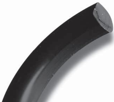
Bild 9.13 Schäden durch Abrieb als einseitige Abflachung an der Innenseite erkennbar
